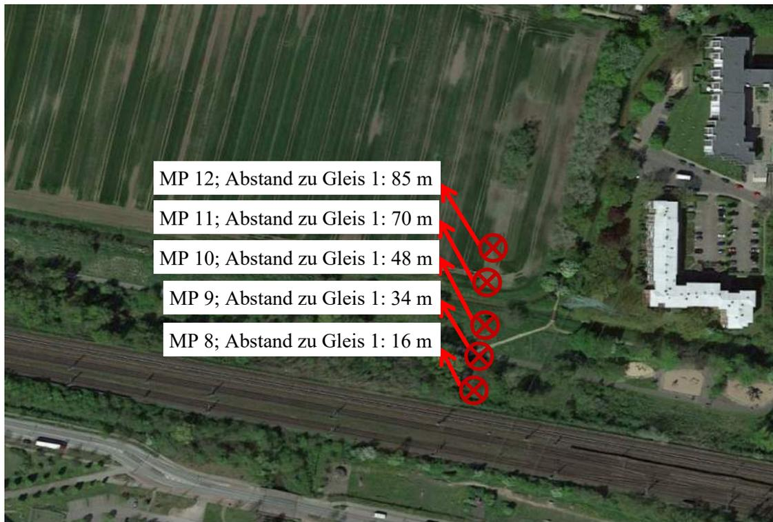
Abbildung 4: Messort 3 mit den Messpunkten 8 - 12 im Lageplan des Planungsgebietes
