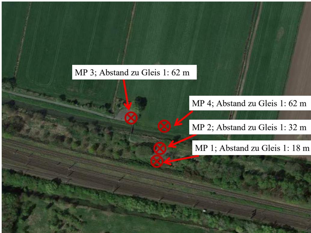
Abbildung 2: Messort 1 mit den Messpunkten 1 - 4 im Lageplan des Planungsgebietes
