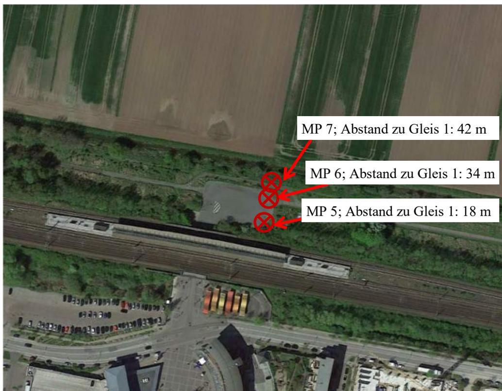
Abbildung 3: Messort 2 mit den Messpunkten 5 - 7 im Lageplan des Planungsgebietes
